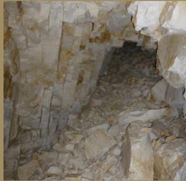
B153 B154 Discontinuités plus ou moins verticales : les diaclases - PHT
