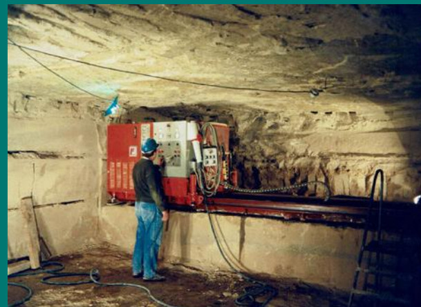
A91 Abattage à la haveuse à Courville jusqu'en 2003 - PHT
